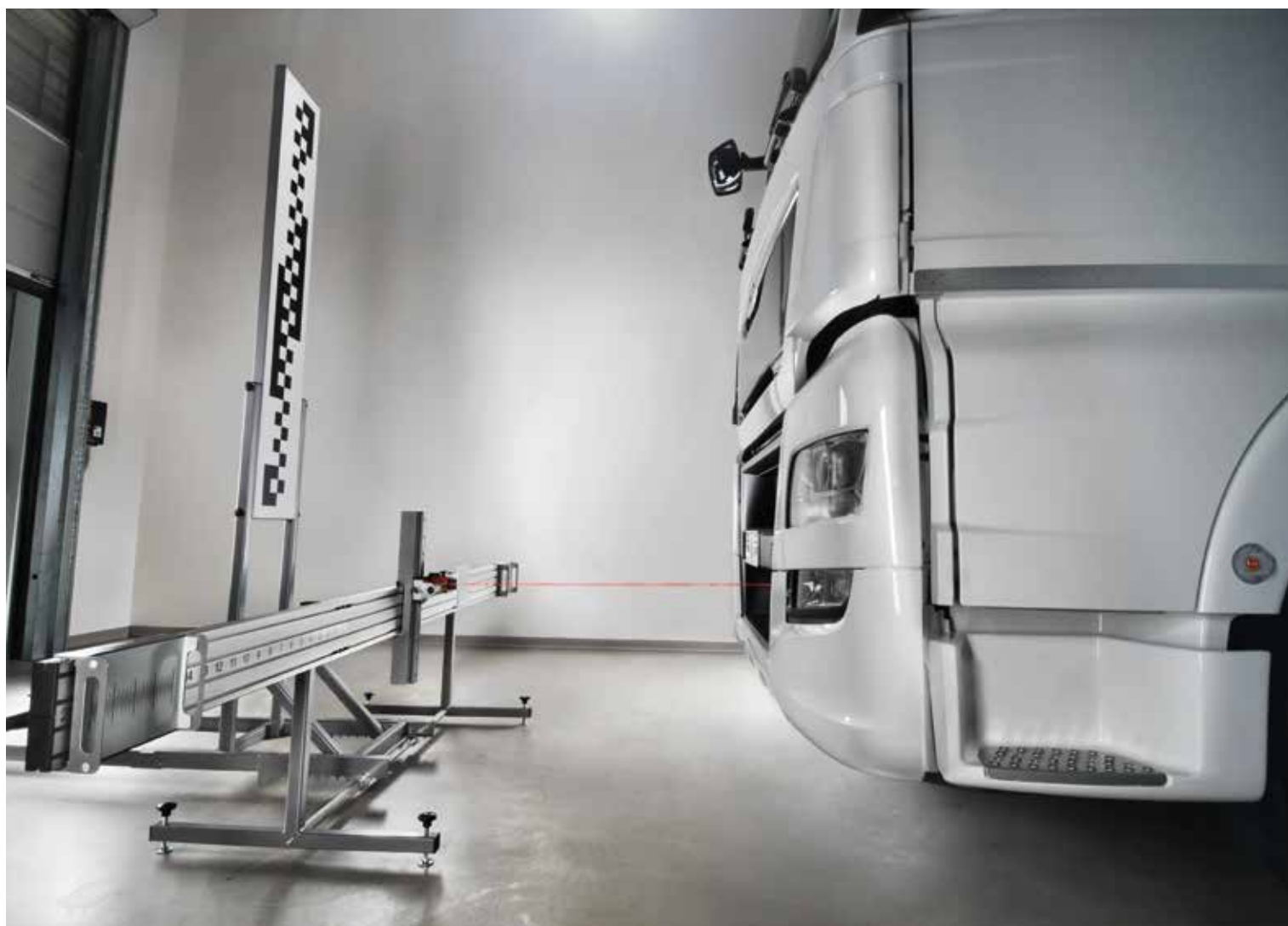
Scala graduata magnetica per controllo allineamento telaio
